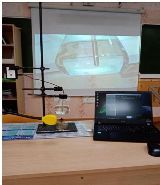
Лабораторная работа с применением электронного термометра «Сравнение количества теплоты при смешивании воды» заключалась в сравнении количества теплоты, которую отдает горячая вода и количества теплоты, которую получает холодная вода при их смешивании. Данная лабораторная работа позволила сравнить полученные результаты при использовании
